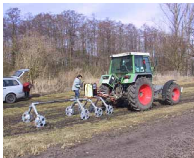
Abb. 4 a/b: Erste (oben) und zweite (unten) Variante eines schleppergezogenen rollenden Elektrodensystems
