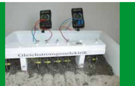
Abb. 2: Laborvariante eines rollenden Elektrodensystems
