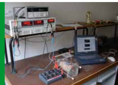
Abb. 1: Labormessplatz zur Bestimmung der elektrischen Leitfähigkeit von Lockermaterial in einer Messzelle
