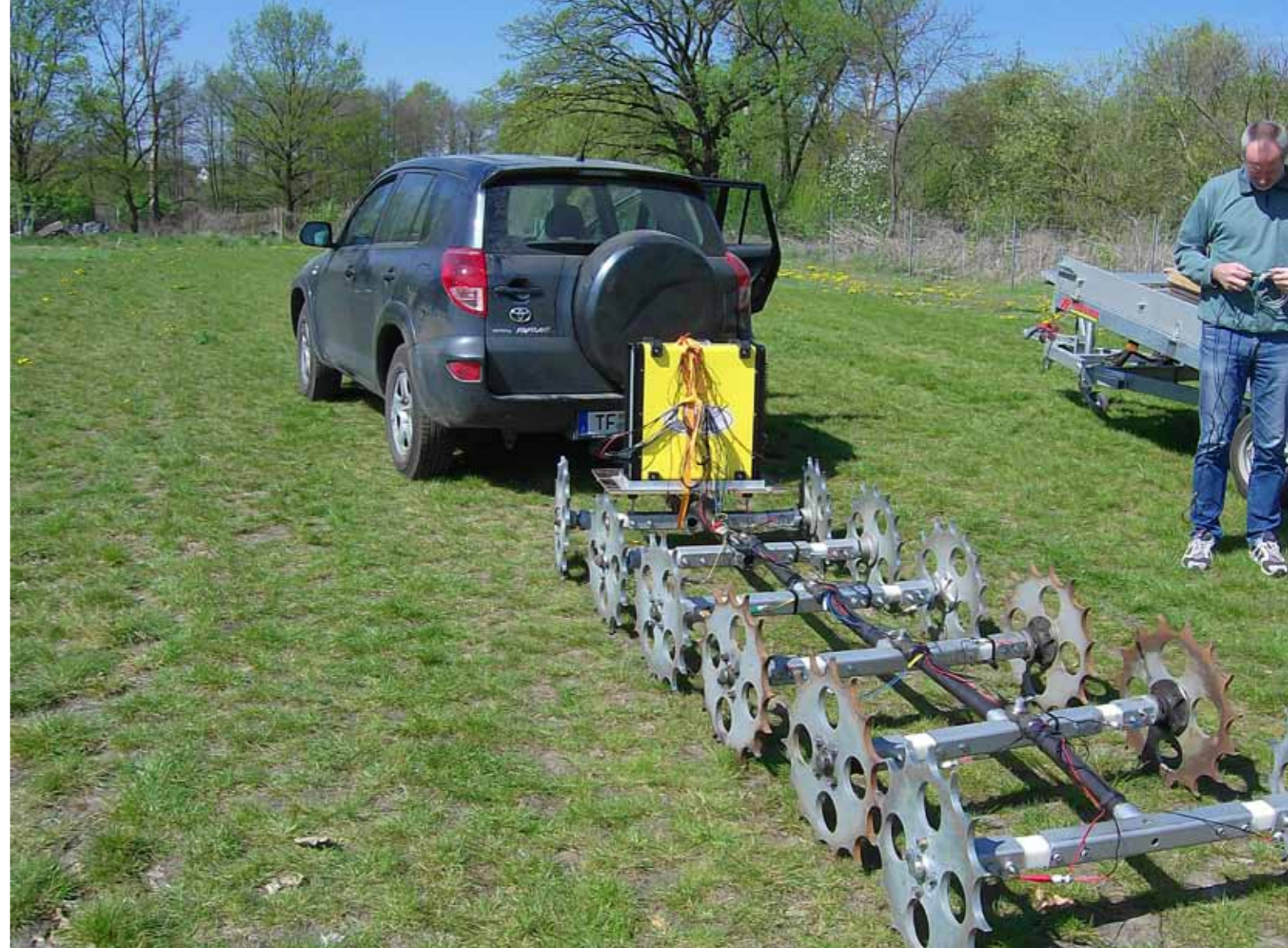
Abb. 5: Aktuelle Variante des Geophilus-Messsystems
